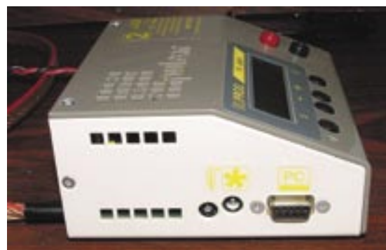
Fot. 2. Ścianka boczna z gniazdami do podłączenia czujnika temperatury zewnętrznego wentylatora oraz komputera PC
