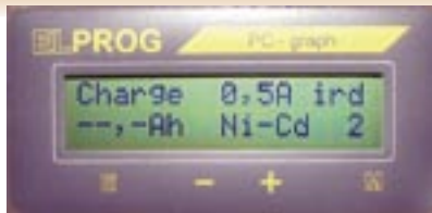
Fot. 12. Programowanie jednego z 8 programów – ustawianie prądu ładowania
