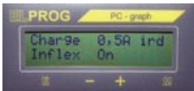
Fot. 9. Programowanie jednego z 8 programów – Tryb Inflex On-Off
