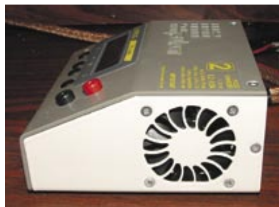
Fot. 3. Widok na wentylator ładowarki
