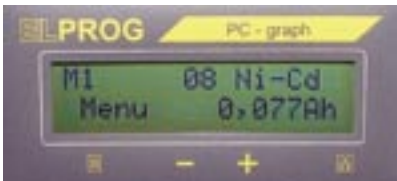
Fot. 6. Pamięci umożliwiają odczyt jednego z ośmiu ostatnich procesów
