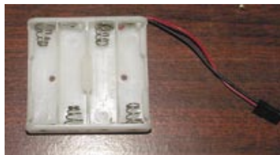
Fot. 19. Pojemnik do ładowania pojedynczych ogniw AA wykonany przez autora testu
