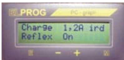
Fot. 10. Programowanie jednego z 8 programów – Tryb Reflex On-Off
