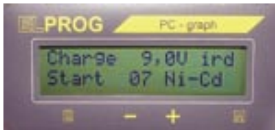
Fot. 13. Po podpięciu pakietu Pulsar oszacowuje liczbę ogniw, którą można skorygować przyciskiem
