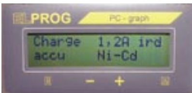
Fot. 8. Programowanie jednego z 8 programów – rodzaj akumulatora
