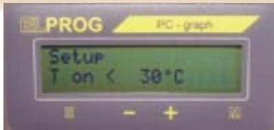
Fot. 5. Ustawianie temperatury pakietu, poniżej której rozpocznie się ładowanie
