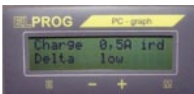
Fot. 11. Programowanie jednego z 8 programów – Delta Hi-Low
