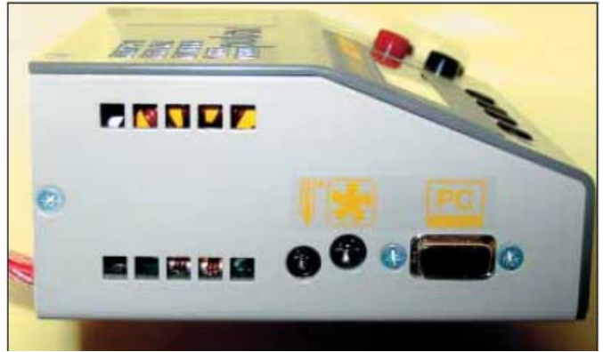
Prawa strona: podłączenie czujnika temperatury, wentylatora i podłączenie do PC
